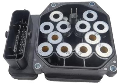
汽车电子稳定系统控制器
